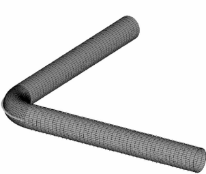
图 5 直埋弯头管段有限元模型
